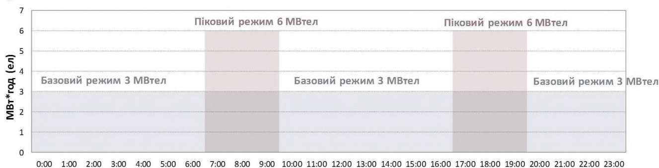
Рис. 4. Режими роботи базової та балансувальної ТЕЦ на біомасі протягом доби.
