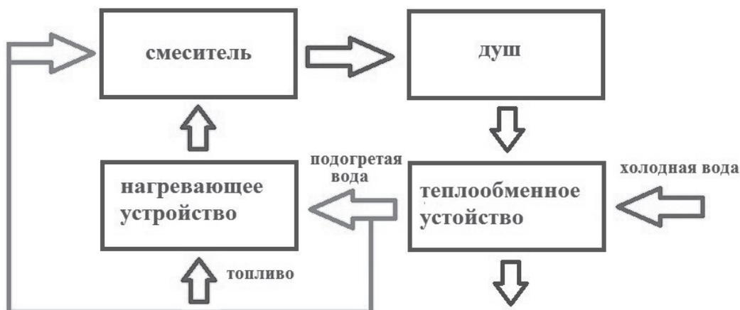
Рис. 1. Схема движения жидкостей при использовании устройства для утилизации теплоты сточных вод.
