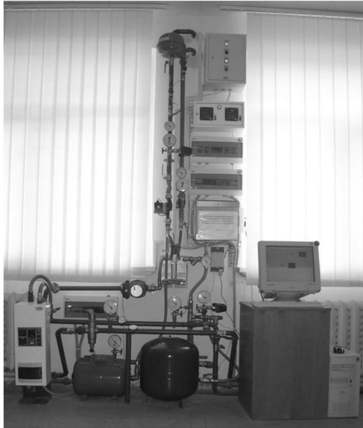
*Рис. 2. Оригінальна схема підключення теплового насоса типу «повітря-рідина».*
