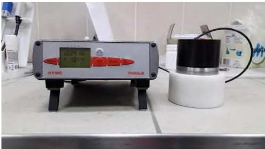
Рис. 1. Аналізатор активності води Hygrolab-2
