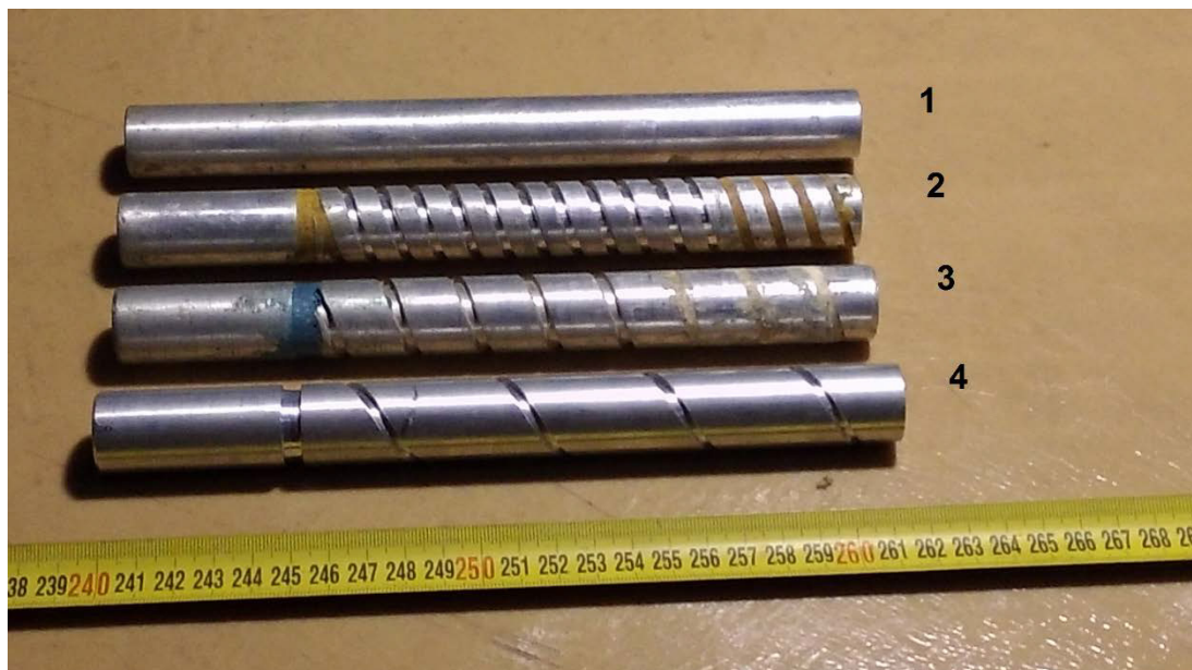
Рис. 1. Фото циліндрів, з однією спіральною канавкою на зовнішній поверхні: 1 – циліндр з гладкою поверхнею; 2, 3, 4 – циліндри зі спіральними канавками, крок спіралі: 2 – 10 мм ; 3 – 20 мм ; 4 – 40 мм
