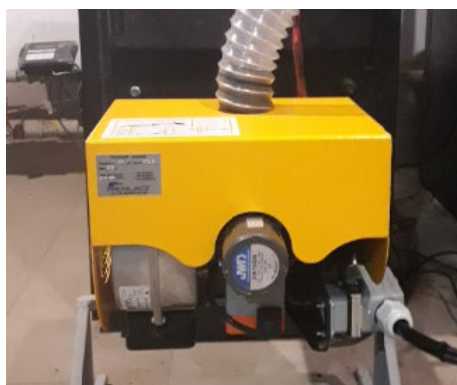
Рис. 2. Автоматичний пальник із рухомим скребком на поді
