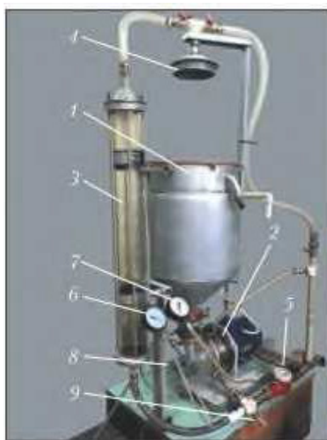
Рис. 3. Аераційно-окиснювальна установка роторного типу (АОРТ):
