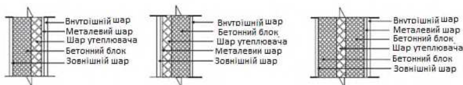
Рис. 5. Структура утеплення фасадів будівлі
