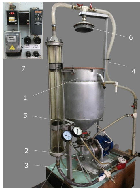
Рис. 1. Аераційно-окиснювальна установка роторного типу: 1 – реактор; 2 – роторно-пульсаційний апарат; 3 – триходовий кран; 4 – контур рециркуляції; 5 – фільтраційна колона; 6 – розпилювальна голівка; 7 – блок управління і контролю
