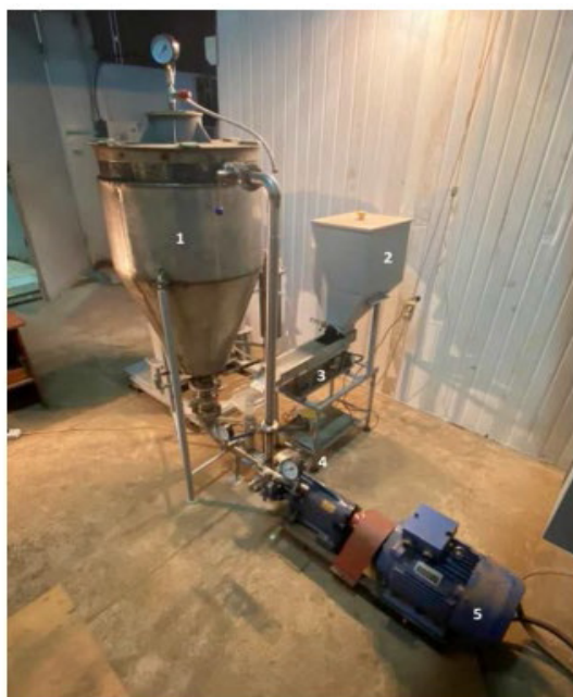
Рис. 5. Зовнішній вигляд тепломасообмінної установки: 1 – приймальний бункер; 2 – смонтована для сировини; 3 – вібродозатор; 4 – РПА; 5 – електродвигун
