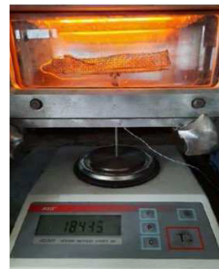
Рис. 1. Зовнішній вигляд сушильної камери із застосуванням інфрачервоних ламп з можливістю регулювання теплового потоку від 100 Вт/м 2 до 3800 Вт/м 2
