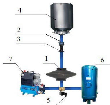
Рис. 1. Схема пульсаційного екстрактора з комбінованим гідродинамічним пристроєм:
