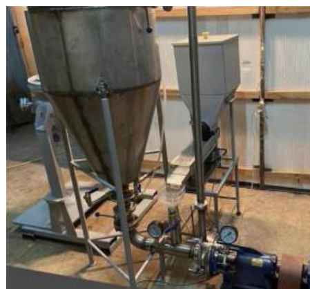
Рис. 3. Ємність для сировини з вібродозатором Fig. 3. Raw material container with vibrating feeder
