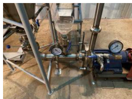
Рис. 6. Зовнішній вигляд РПА, підшипникового та сальникового вузлів
