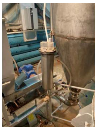
Рис. 5. Проточний водонагрівач з контролером регулювання температури
