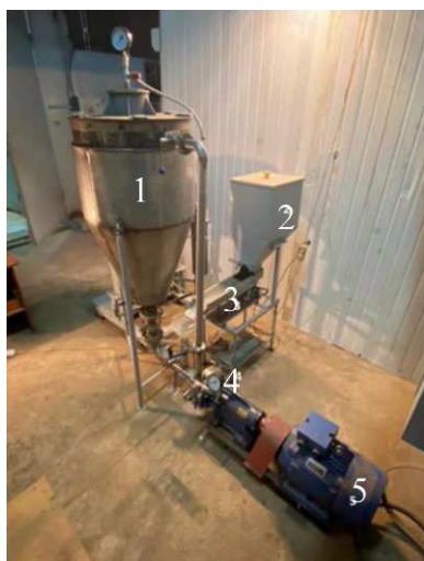
Рис. 2. Зовнішній вигляд дослідно-промислової установки: 1 – приймальний бункер; 2 – ємності для сировини; 3 – вібродозатор; 4 – РПА; 5 – електродвигун Fig. 2. Appearance of the pilot plant: 1 – receiving hopper; 2 – raw material tanks; 3 – vibrating feeder; 4 – RPA; 5 – electric motor
