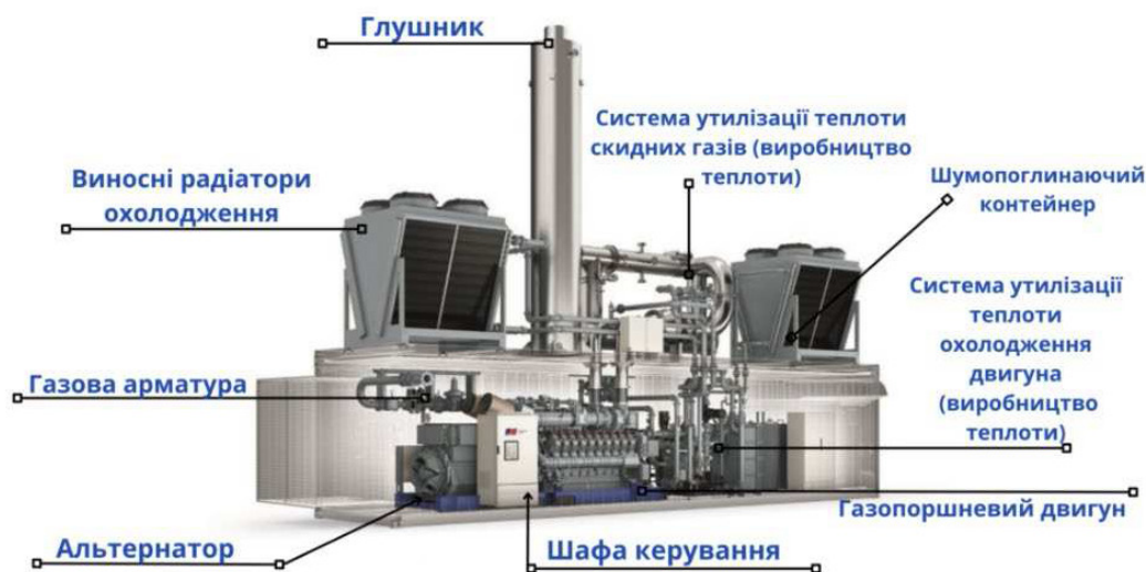
Рис 3. Типова будова газопоршневої КГУ у контейнерному виконанні [9]
