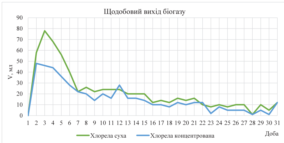
Рис. 3 Вихід біогазу із зразків біомаси Chlorella vulgaris
