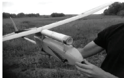
Рис. 5. Фото ФЕП, встановленого на БПЛА.
