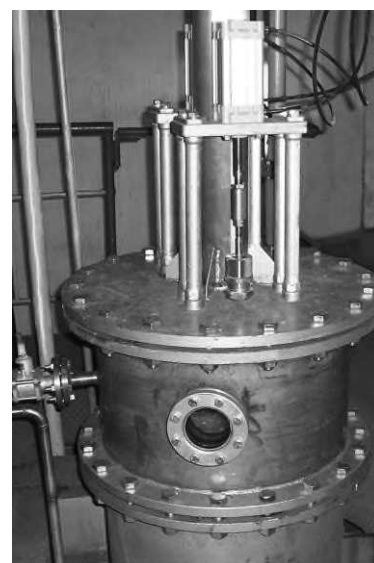
Рис. 2. Фрагмент розгінної колони циклічної дії
