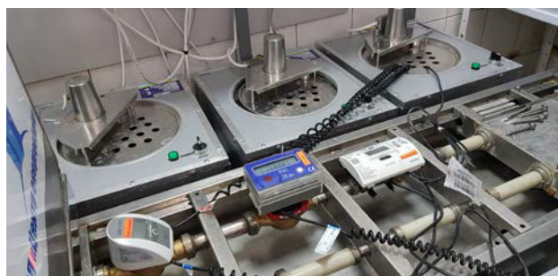
Рис. 4. Еталон для повірки єдиного теплолічильника
