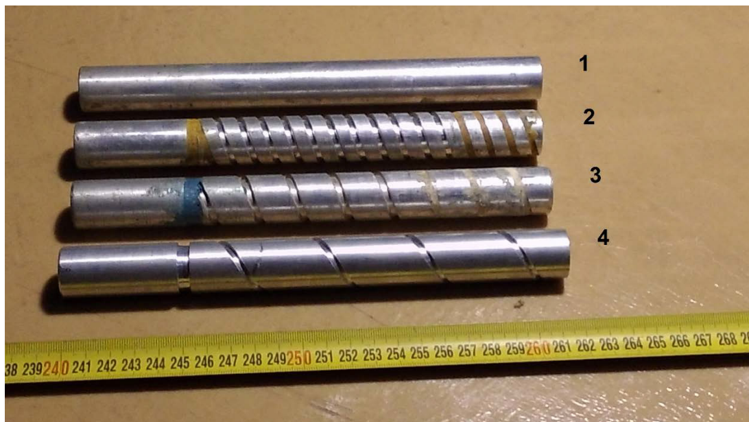
Рис. 1. Фото циліндрів, з однією спіральною канавкою на зовнішній поверхні: 1 – циліндр з гладкою поверхнею; 2, 3, 4 – циліндри зі спіральними канавками, крок спіралі: 2 – 10 мм ; 3 – 20 мм ; 4 – 40 мм
