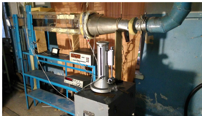
Рис. 1. Аеродинамічна труба для дослідження теплообміну і аеродинаміки при обтіканні повітрям пучків циліндрів
