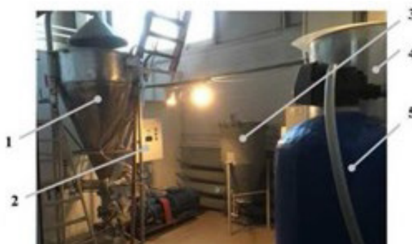
Рис .2. Дослідно-промислова установка АОРТ продуктивністю 20-40 м3/год: 1 – АОРТ; 2 – блок управління; 3 – ємність подачі води на фільтр; 4 – фільтр; 5 – збірник готової продукції
