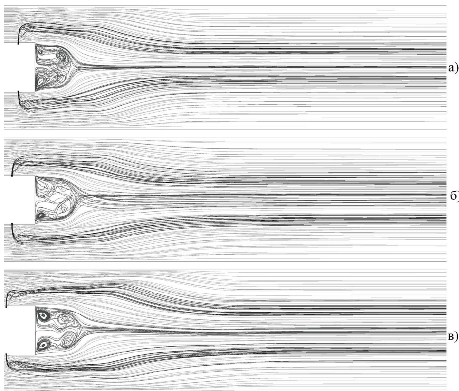
Рис. 2. Картина ліній току у поздовжньому перерізі стабілізатора полум'я, що проходить через вісь газоподавальних отворів, при подачі палива у першу (а), другу (б) та третю (в) секцію
