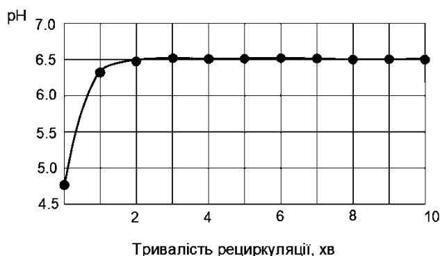
Рис. 6. Залежність зміни pH кислого конденсату від тривалості його обробки в установці НБ Fig. 6. Dependence of the change in pH of acid condensate on the duration of its treatment in the non-reagent neutralizer installation
